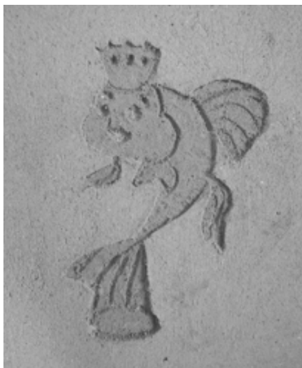
Рис. 1. Экспериментальный образец штукатурки сграффито «Золотая рыбка»
