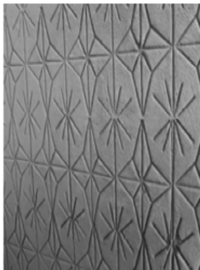
Рис. 2. Экспериментальный образец штукатурки, отделанной штампом
