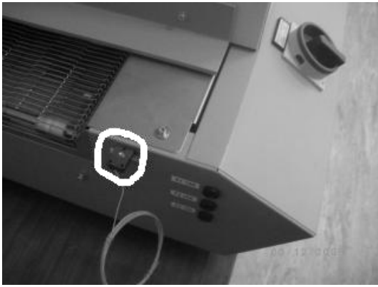
Рис 48.. Подключение дополнительных термопар.
