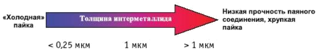
Рис.3.Зависимость прочности паяльного соединения от толщины интерметаллида
