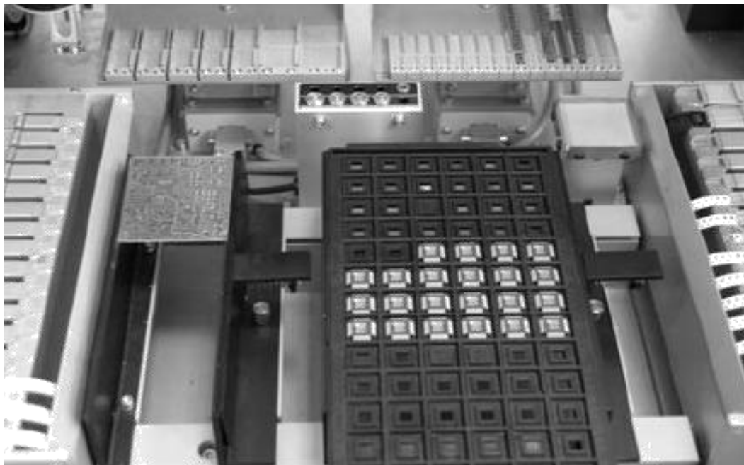
Рис. 33. Установка компонентов с палет
